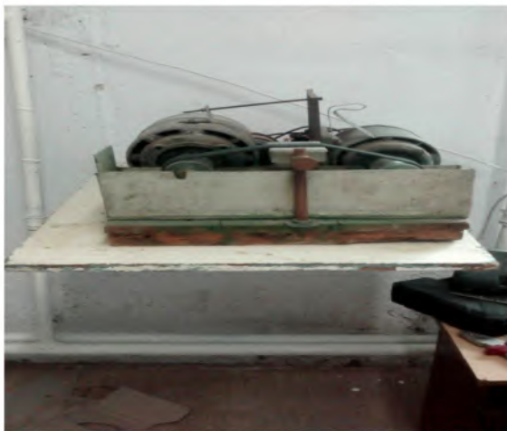
Рис. 3. Машинка для получения шлифов
