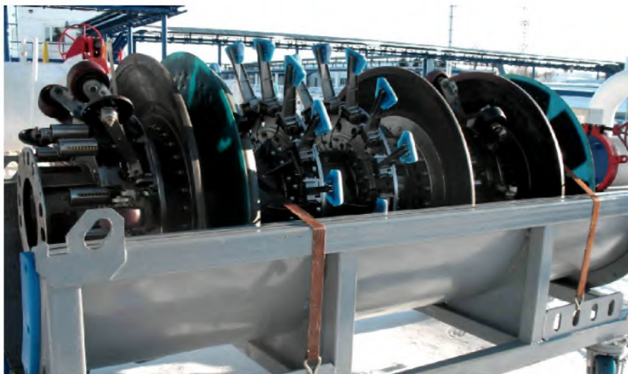
Рис. 1. Общий вид профилемера.
