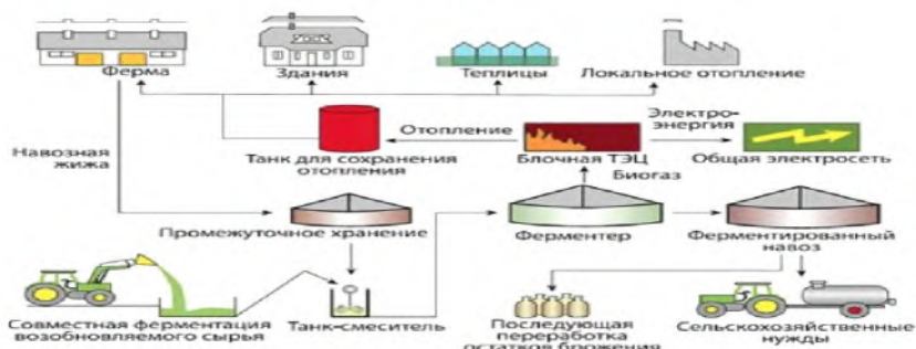
Рис. 1. Схема установки промышленного автоматизированного комплекса по получению биогаза
