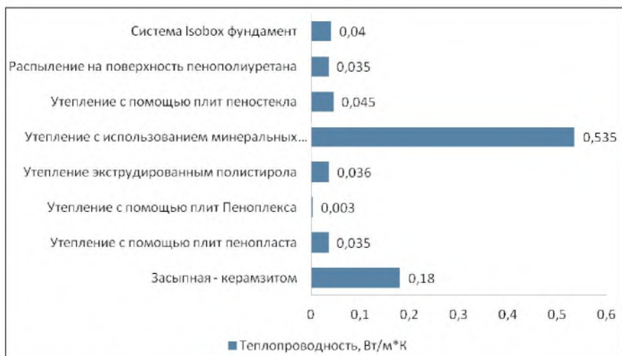
Рис. 4. Показатели теплопроводности теплоизоляции фундаментов
