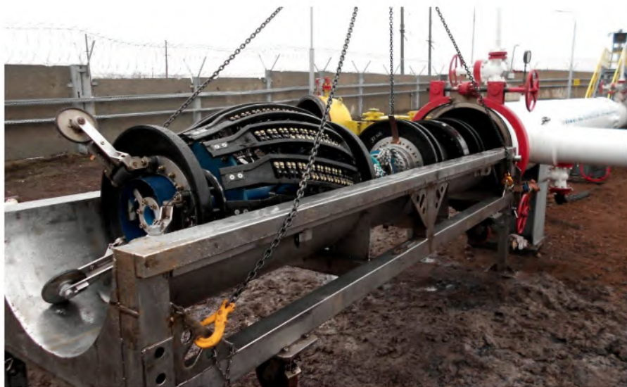
Рис. 2. Общий вид внутритрубного дефектоскопа.
