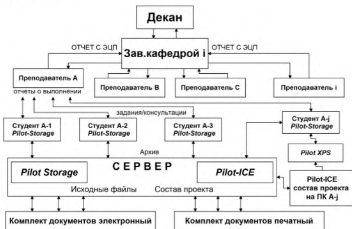
Рисунок 1. Схема системы управления учебными проектами в Pilot-ICE
